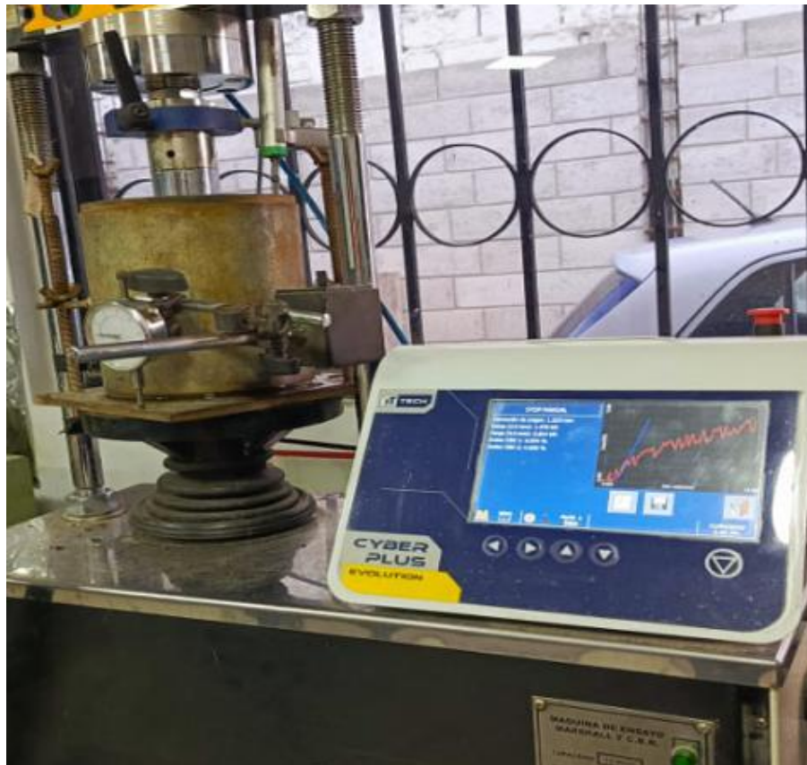
Fotografía 7 Ensayo de CBR
