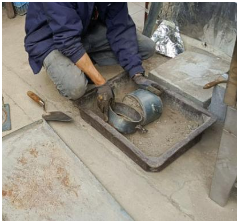
Fotografía 6 Ensayo de compactación
